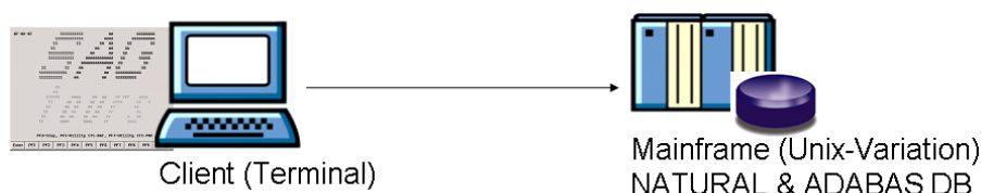
Abb. 1: 1-Tier Systemarchitektur der existierenden Mainframe-Altanwendung
